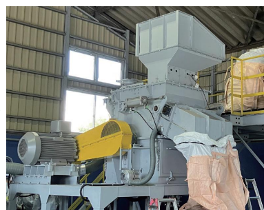
PTP剥離装置（オリックス環境株式会社設置）
