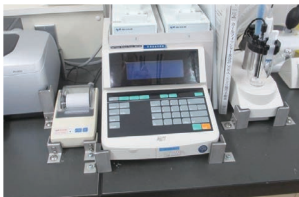
試験機器の落下防止（栃木工場）
